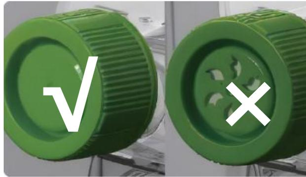
图示：密封瓶盖（左）和透气瓶盖（右）
